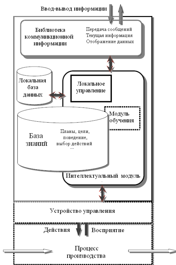
Рис. 7. Архитектура производственного агента из работы Б. Кадара [13]
