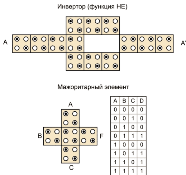
Рис. 3. Два основных логических элемента в технологии квантовых клеточных автоматов: инвертор, или вентиль НЕ (вверху), и мажоритарный вентиль (внизу). ( https://www.electronicdesign.com/technologies/analog/article/21796222/the-quest-for-zero-power-logic )
