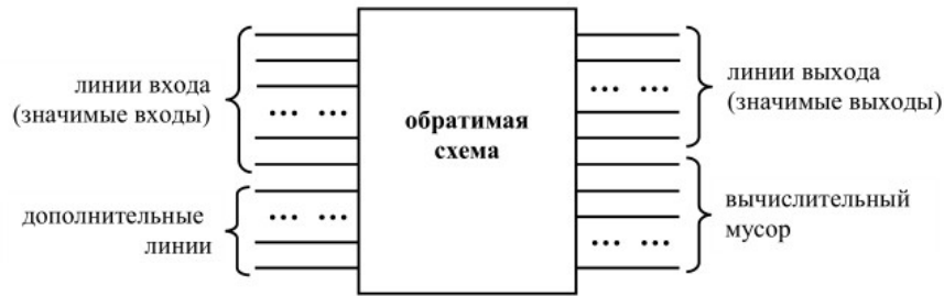
Рис. 10. Входы и выходы обратимой схемы
