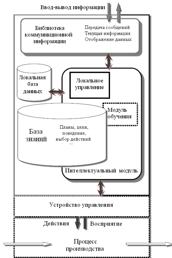
Рис. 7. Архитектура производственного агента из работы Б. Кадара [13]
