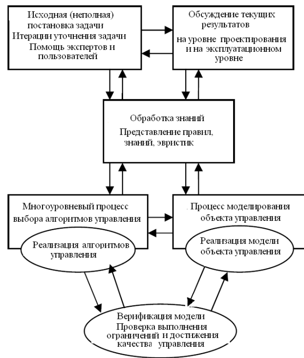
Рис. 1. Схематическое представление процесса разработки систем интеллектуального управления [12]
