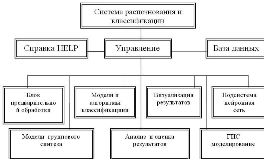
Рис. 1. Концептуальная модель системы распознавания и классификации
