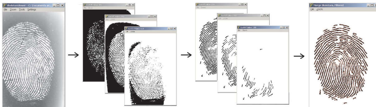
Рис. 3. Серое изображение – бинарные «срезы» – фрагменты бинарных изображений, восстановленные на основе «почищенных» скелетов – итоговый скелет серого изображения и бинарное изображение, на основе которого он строится
